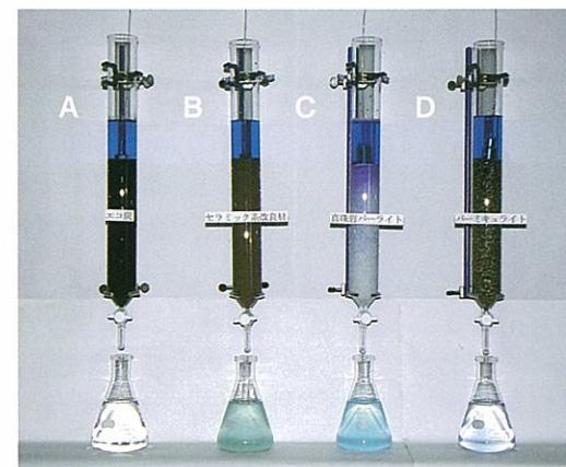
【写真-4】エコ炭の吸着試験
